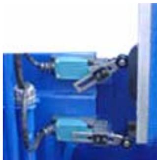
Los puntos "A" y "B" se determinan por medio de los microswitches y levas.
